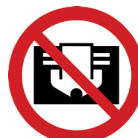
Heizgerät nicht abdecken
